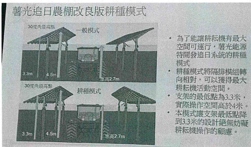
圖 17：綠源科技公司薯光追日農棚使用農耕機的設計圖。圖片來源：陳婉娥翻攝(2022/12/21 日)。
