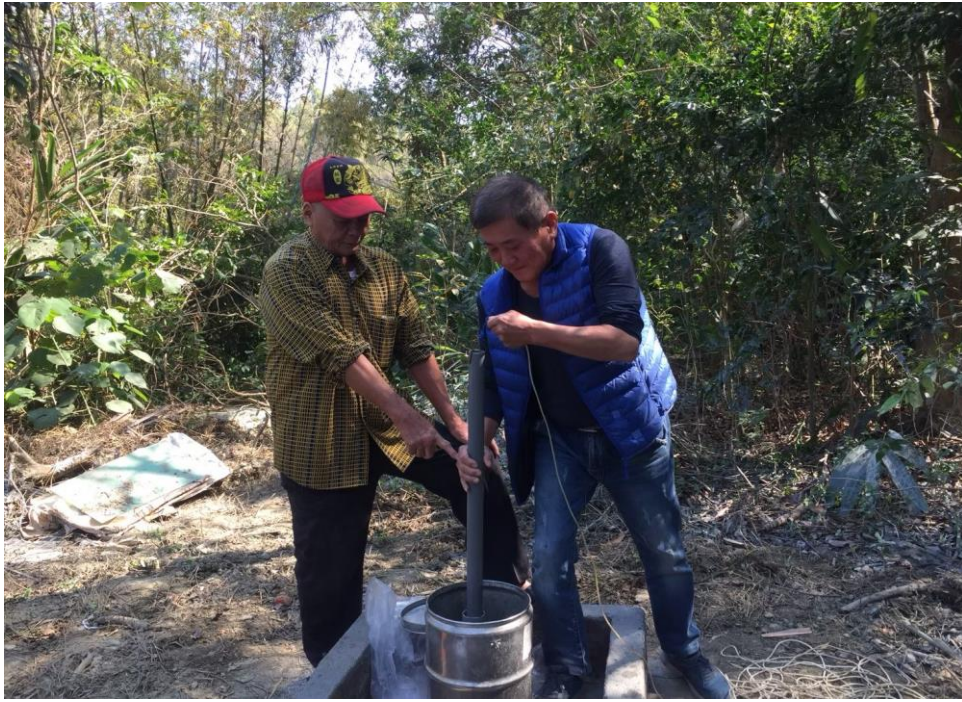
台南龍崎歐欣地下水水井水位量測及水質檢測
