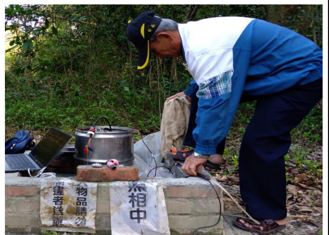
志工美 2-3 天量測地下水水位，手拿測量儀器
