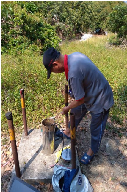
檢測東山掩埋場地下井水位
