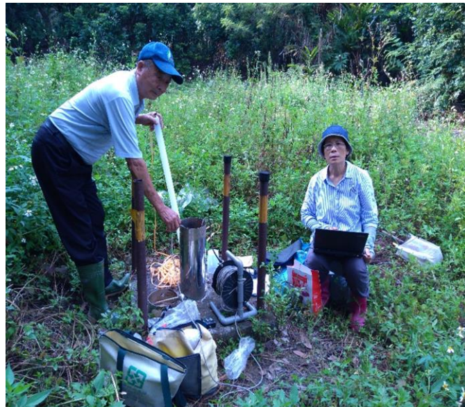
電腦接上測量儀器讀取資料，紀錄水位
