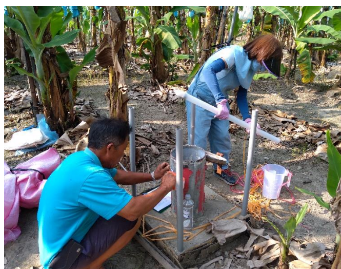
取水的練習，過程必須清洗汲管子跟水杯
