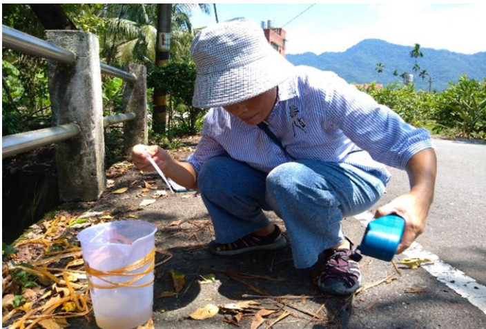
教導檢測前儀器需用蒸餾流水清洗，以免有誤差
