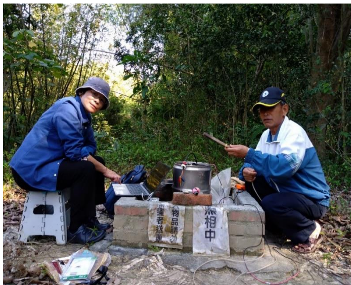
志工手上拿的就是測量水位的儀器
