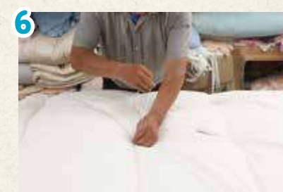
6 手工縫被／用針線將棉片與被單縫牢固定
