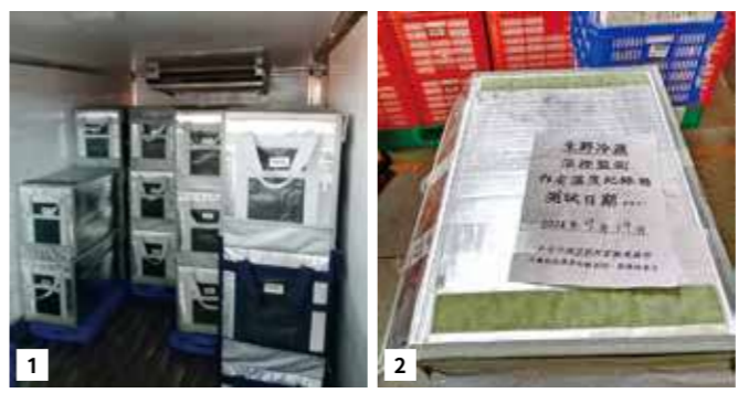
1 物流減碳計畫中，冷藏運輸車不開空調以保冷箱進行運輸，藉此測試保冷箱效果、車載運量、以及箱體碰撞耐受度與對保冷的影響。 2 測試保冷箱搭配保冷片的冷藏效果，運輸全程使用溫度紀錄器記錄保冷箱中的溫度變化。
