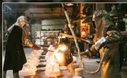
將熔融鐵水注入陶瓷模具，高溫澆鑄，成就大古鍋的雛形。
