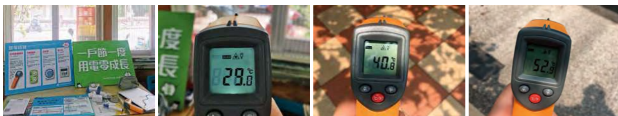
新營站以植物棚架做為天然隔熱，站外太陽直曬柏油路面溫度52°C、棚架遮蔭下地面36至40°C、室內玻璃溫度29°C。
