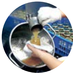
4 採熱填充讓果醬成真空填裝，火候掌握是關鍵，一但冷掉，味道就變了。
